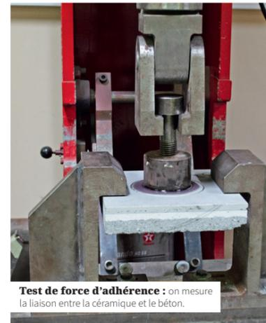
Test de force d'adhérence : on mesure la liaison entre la céramique et le béton.
